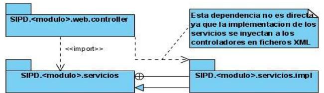
Vista Lógica - Patrones Inyección de dependencia y Bajo Acoplamiento en la Aplicación Web.
